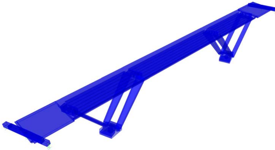
Σχ. 6 Προσομοίωμα Άνω Διάβασης A296 για την ανάλυση υπό σεισμικά φορτία.
